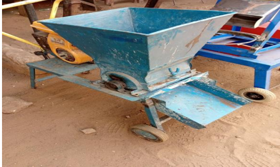
Illustration 1 : Broyeuse du manioc fabriquée
