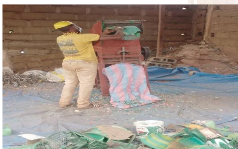
Photo 6 : opération de broyage des sachets plastiques
